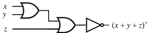
Perhatikan bahwa ekspresi  $(x + y + z)'$  ekuivalen dengan  $x'y'z'$  pada poin (c) di atas, yaitu dengan menggunakan hukum De Morgan. Namun rangkaian logika dari  $x'y'z'$  memerlukan 5 gerbang, sedangkan rangkaian logika dari  $(x + y + z)'$  memerlukan lebih sedikit gerbang, yaitu hanya memerlukan 3 gerbang.
